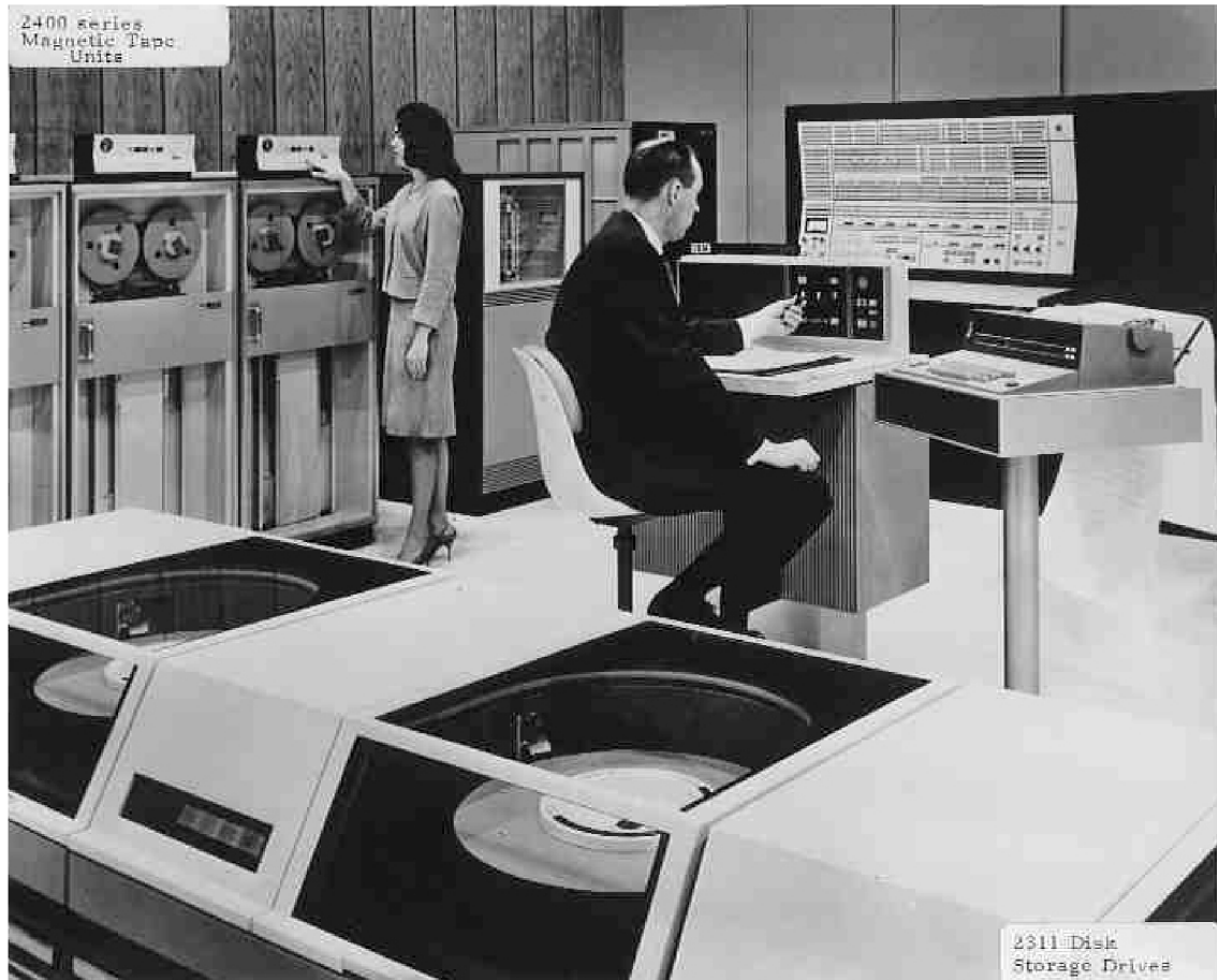
Discos duros modelo 2311 de IBM a los que se hace referencia, con capacidad de 7'5Mbytes. [FUENTE: http://www.columbia.edu/acis/history/2311.html ]
